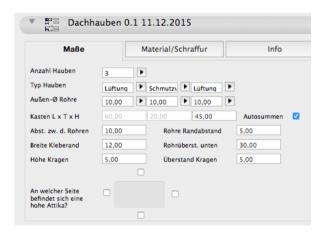
Die Kastengröße können Sie auf 2 Arten festlegen: a) als Autosumme: dann wird Länge und Tiefe als Summe aus den Rohrdurchmessern, den Rohrabständen und den Randabständen berechnet; b) manuell: dann können Sie Länge, Tiefe und Randabstand eingeben und die Rohre werden entsprechend mit gleichmäßigem Rohr-
