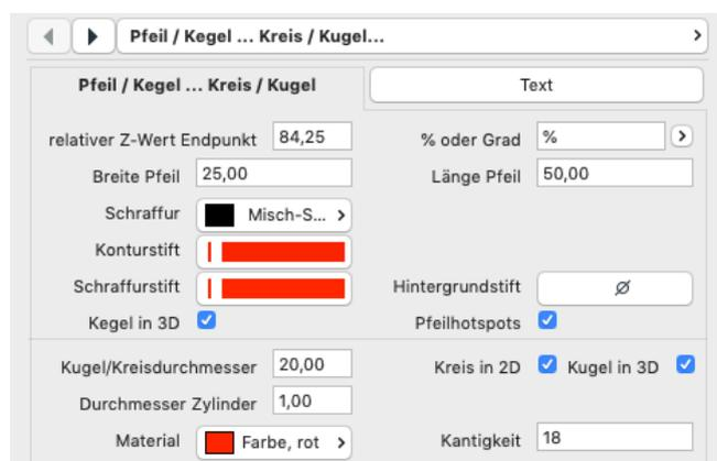
Einige Elemente sind in 2D bzw. 3D ein- oder ausblendbar. Die Kantigkeit gibt an, wieviele Polygonkanten der Zylinder bzw. der Kegel/die Kugel bezogen auf 360° besitzen.
