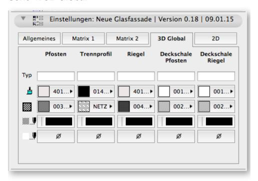
Hier stellen Sie für die Elemente: Pfosten, Trennprofil, Riegel, Deckschalen folgende Attribute ein: Typ (Auswahl aus einem Herstellerangebot), Material, Schraffur, Schraffurtifte (Vordergrund und Hintergrund).
